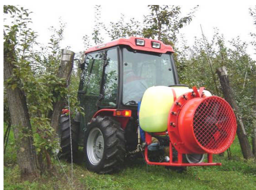
Gebläsespritze mit Heckrotor
